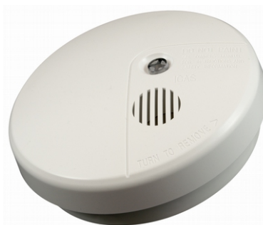
Branddetektor 500-IDx: (x=O, I, T, OT, Re) O: Optisk, I: jonisk, T: Termisk, Re: reläsockel OT: Multikriterie optisk/termisk D=118mm, H=36mm (H=42mm inkl sockel)
